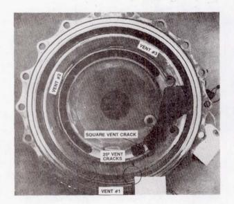
FIGURE 23.- TYPICAL EXHAUST HOUSING CRACKS.
