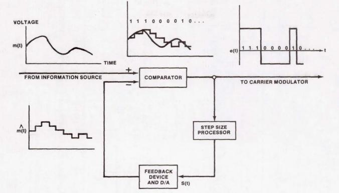
FIGURE 3.- DELTA MODULATION PROCESS.
