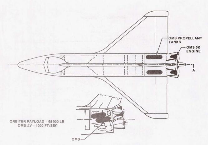
FIGURE 4.- ORBITER 040C CONFIGURATION.
