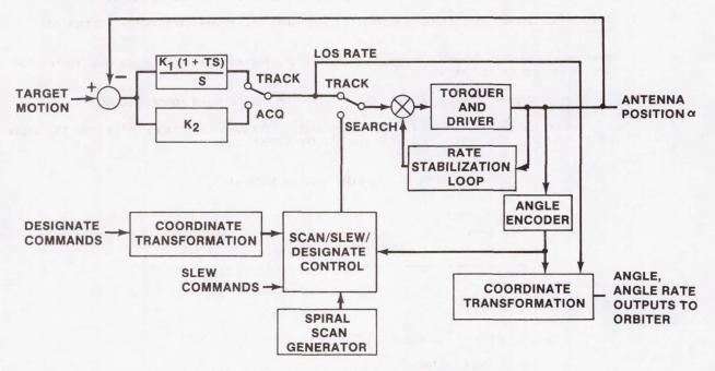
FIGURE 3.- ANGLE TRACKING SERVO BLOCK DIAGRAM.
