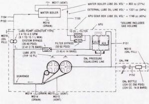
FIGURE 20.- APU LUBRICATION SYSTEM.
