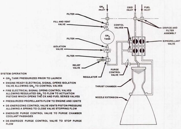
FIGURE 12.- OMS ENGINE SCHEMATIC.
