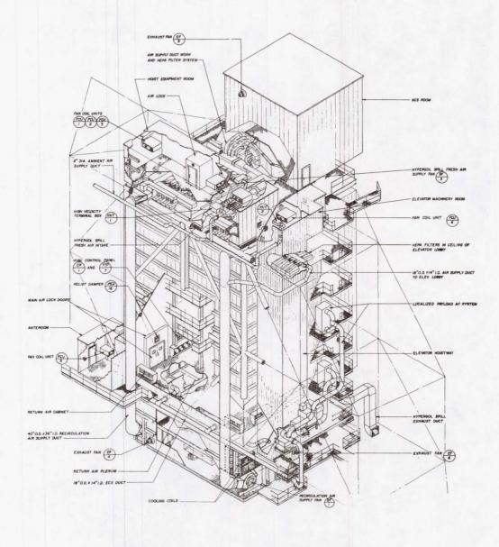
FIGURE 9. PCR CONTROLLED ENVIRONMENT SYSTEM
