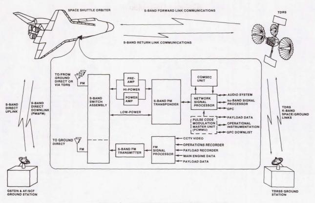
FIGURE 1.- ORBITER OPERATIONAL S-BAND SYSTEM.
