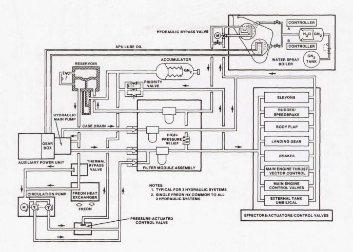
FIGURE 1.- ORBITER HYDRAULIC SYSTEM SCHEMATIC.
