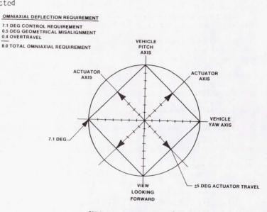
FIGURE 10. SOLID ROCKET MOTOR TVC REQUIREMENTS
