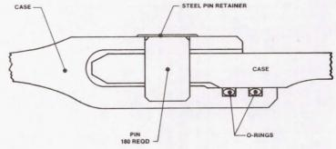
FIGURE 7. SEGMENT JOINT DETAIL
