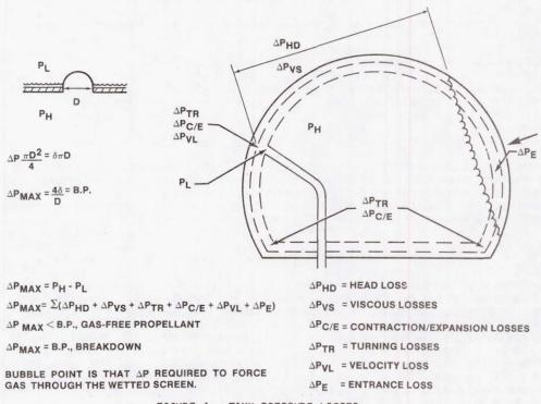
FIGURE 4.- TANK PRESSURE LOSSES.
