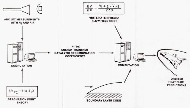
FIGURE 5.- SURFACE CATALYSIS FLIGHT PREDICTION PROCESS.
