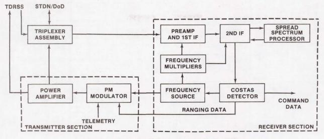
FIGURE 25.- NETWORK TRANSPONDER FUNCTIONAL BLOCK DIAGRAM.
