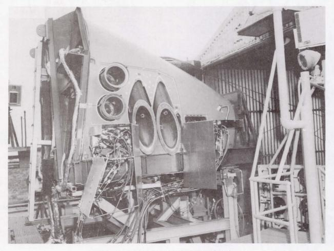
FIGURE 10.- TYPICAL SYSTEM TEST ARTICLE (FRCS).
