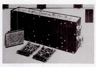
FIGURE 28.- ORBITER APU CONTROLLER.
