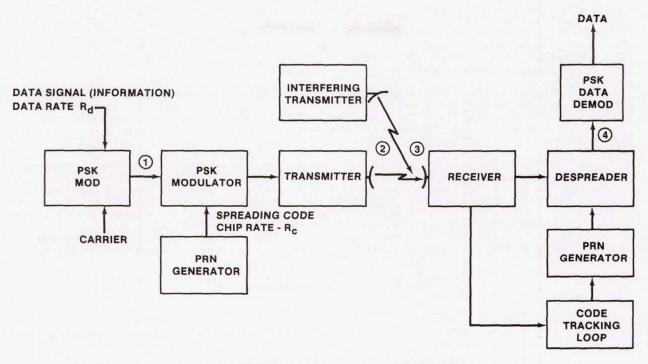
FIGURE 8.- SPREAD SPECTRUM SYSTEM CONFIGURATION.
