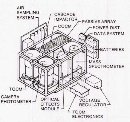
FIGURE 1.- INDUCED ENVIRONMENT CONTAMINATION MONITOR.
