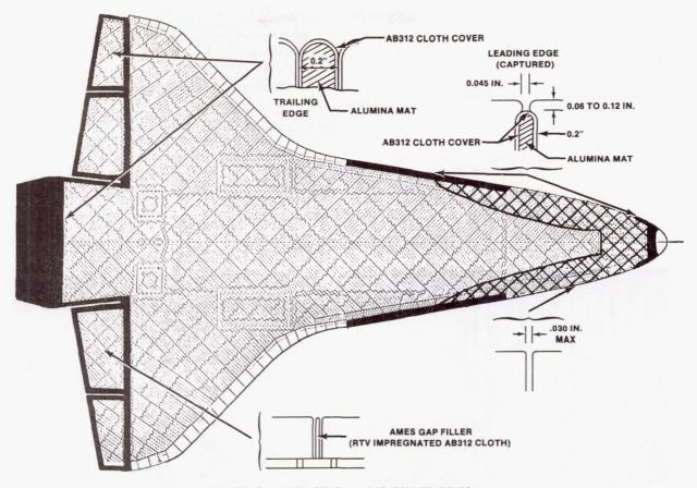
FIGURE 4.- HIGH DELTA-P GAP FILLER ZONES.
