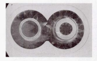
FIGURE 5.- APU FUEL PUMP GEARS, 17 TOOTH/16 PITCH.
