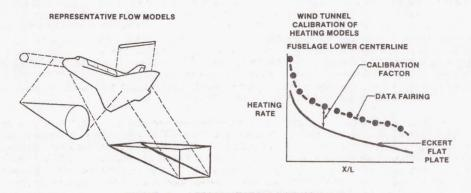
FIGURE 3.- DESIGN HEATING METHODOLOGY.
