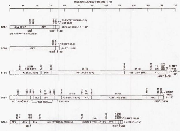
FIGURE 14.- STS FLIGHT TEST ATTITUDE TIME LINE.
