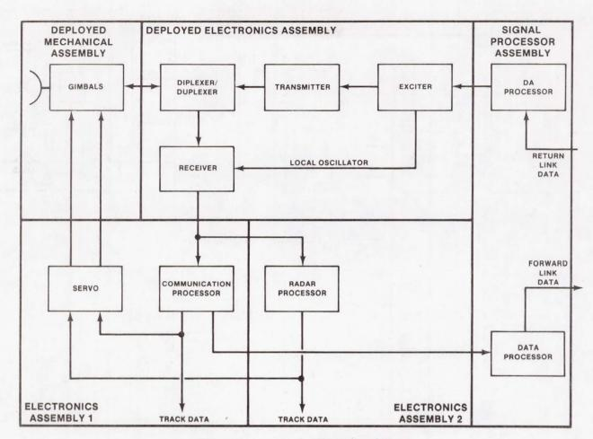
FIGURE 12.- KU-BAND SYSTEM BLOCK DIAGRAM.
