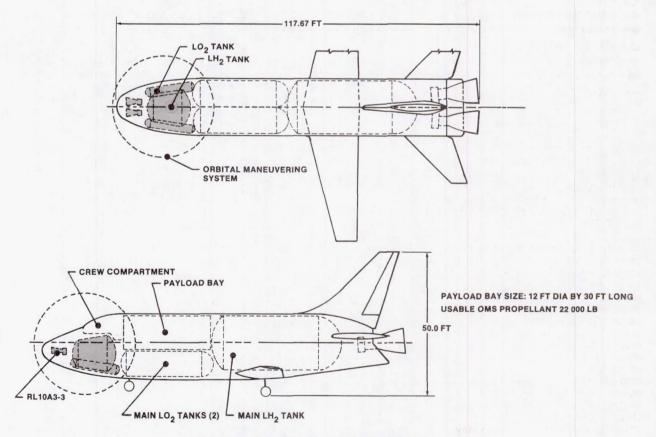
FIGURE 1.- ORBITER CONFIGURATION 009.
