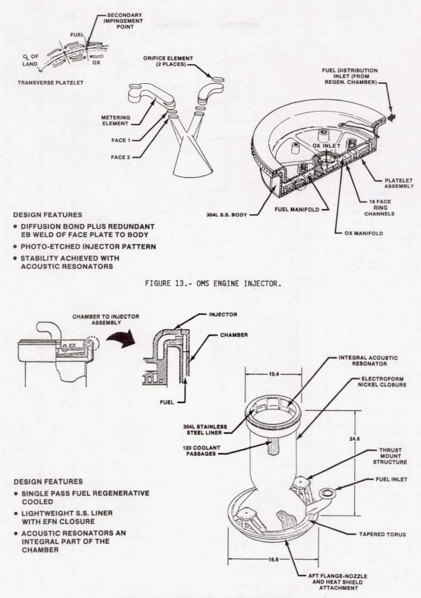
FIGURE 14.- OMS ENGINE COMBUSTION CHAMBER.
