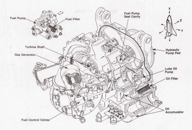
FIGURE 3.- AUXILIARY POWER UNIT ASSEMBLY.
