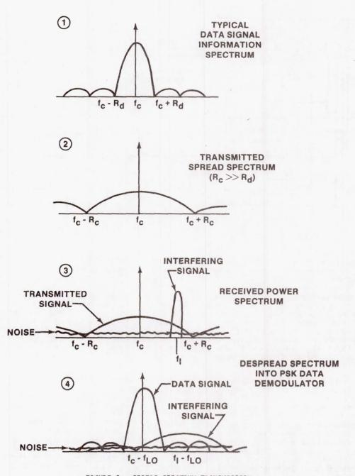
FIGURE 9.- SPREAD SPECTRUM TRANSMISSION.
