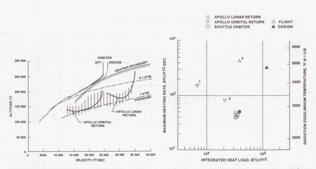
FIGURE 1.- ENTRY FLIGHT REGIMES: APOLLO COMMAND FIGURE 2.- TPS DESIGN AND FLIGHT TEST ENVIRONMENTS. MODULE AND SHUTTLE ORBITER.
