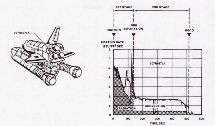
FIGURE 4.- TYPICAL ASCENT BASE HEATING ENVIRONMENT.
