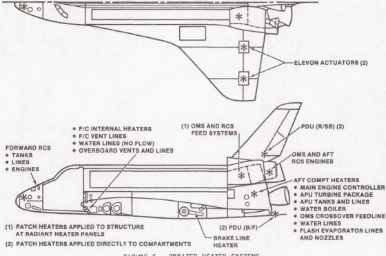
FIGURE 5.- ORBITER HEATER SYSTEMS.
