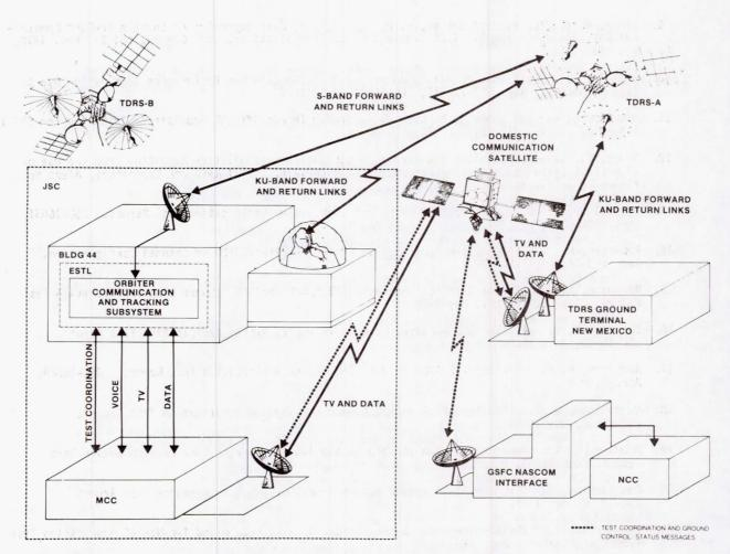
FIGURE 15.- TDRS INTERFACE TEST CONFIGURATION.
