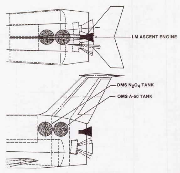
FIGURE 3.- ORBITER CONFIGURATION 013.
