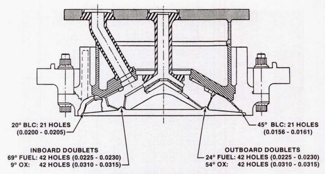
FIGURE 7.- INJECTOR CROSS SECTION.
