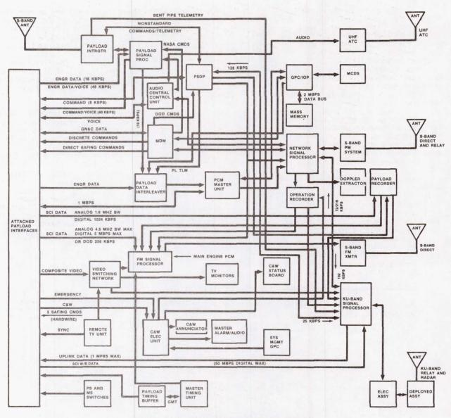
FIGURE 3.- SHUTTLE ORBITER AVIONICS SYSTEM.
