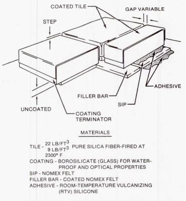
FIGURE 3.- TILE SYSTEM CONFIGURATION.
