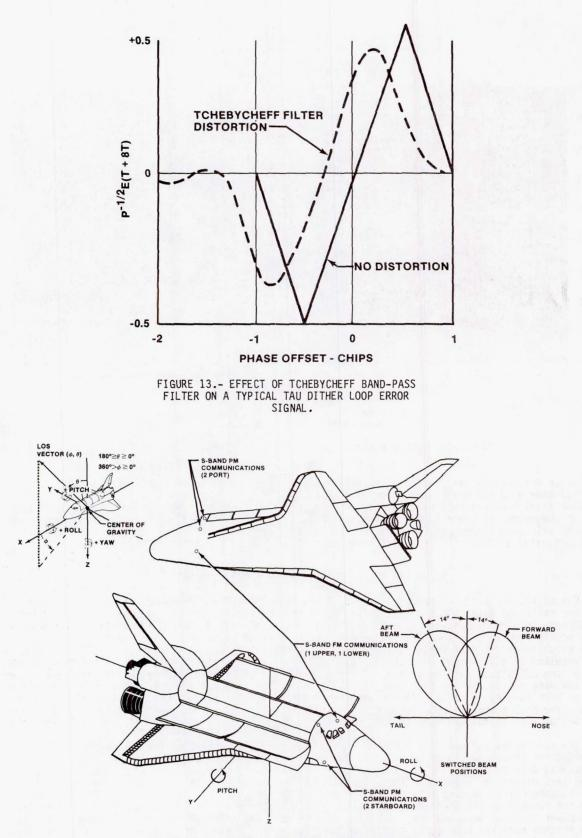
FIGURE 14.- SHUTTLE S-BAND ANTENNA LOCATIONS.
