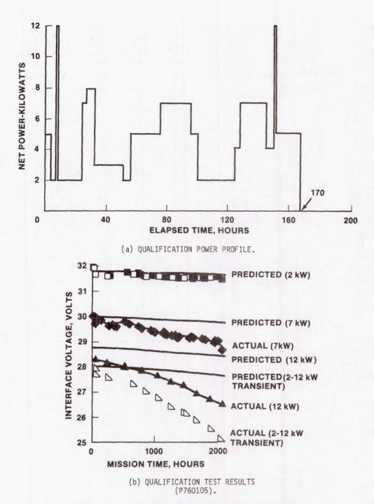
FIGURE 3.- ORBITER FUEL CELL QUALIFICATION PARAMETERS.
