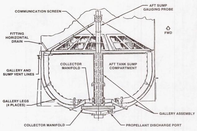
FIGURE 9.- PROPELLANT ACQUISITION SYSTEM.
