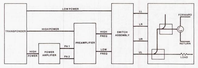
FIGURE 11.- ORBITER S-BAND SYSTEM.
