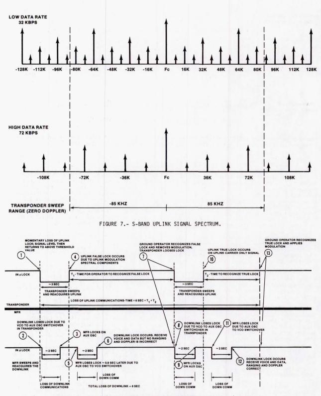
FIGURE 8.- ORBITER-GSTDN TWO-WAY RF REACQUISITION SEQUENCE (JSC/ESTL).
