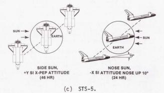
FIGURE 13.- THERMAL TEST ATTITUDES.
