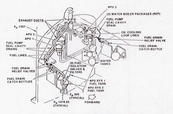
FIGURE 4.- AUXILIARY POWER UNIT SUBSYSTEM INSTALLATION DESCRIPTION.
