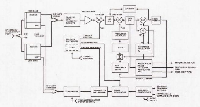
FIGURE 4.- PAYLOAD INTERROGATOR FUNCTIONAL BLOCK DIAGRAM.
