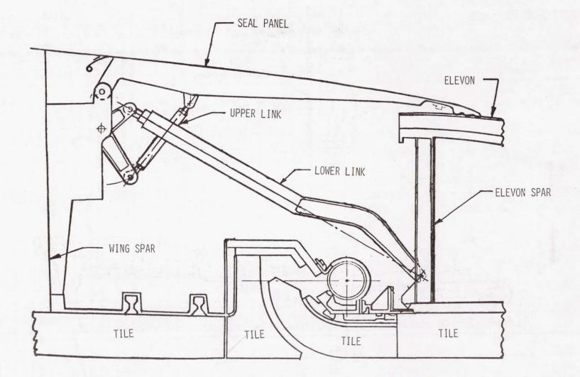
FIGURE 7. FINAL LINKAGE CONFIGURATION (TYPICAL)
