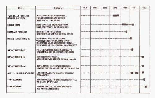
FIGURE 12. DEVELOPMENT/IMPLEMENTATION OF LO2 MAIN FEEDLINE HELIUM INJECTION
