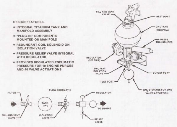
FIGURE 17.- OMS ENGINE VALVE ACTUATION SYSTEM.
