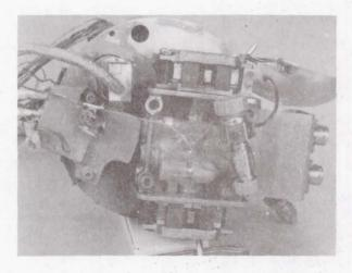
FIGURE 17 .- GGVM DETONATION DAMAGE.
