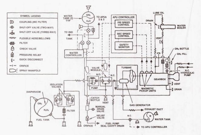
FIGURE 2.- AUXILIARY POWER UNIT SUBSYSTEM SCHEMATIC.
