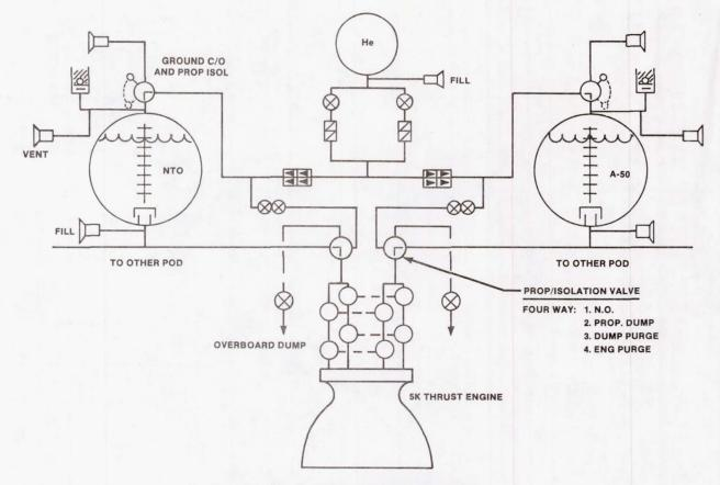
FIGURE 5.- ORBITER 040C OMS SCHEMATIC.
