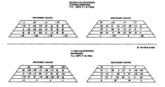
FIGURE 5. GO2 VENT SYSTEM PRESSURE DISTRIBUTION 3/4" INSIDE LOUVERS
