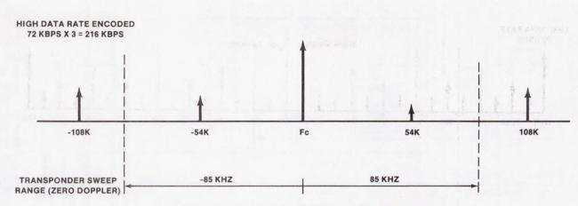
FIGURE 9.- UPLINK ENCODED 72-kbps SIGNAL SPECTRUM.
