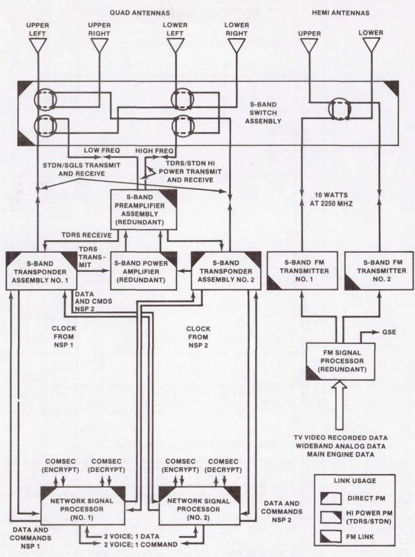
FIGURE 24.- S-BAND NETWORK COMMUNICATION EQUIPMENT.
