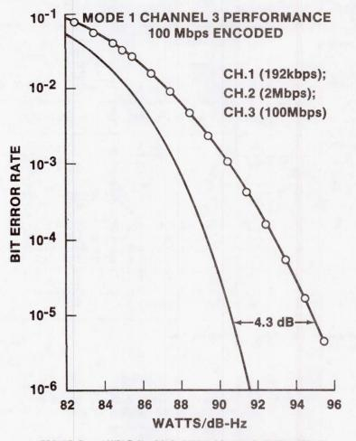
FIGURE 5.- SAMPLE Ku-BAND COMMUNICATIONS TEST RESULTS.
