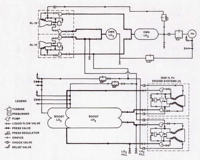
FIGURE 2.- ORBITER FEED AND PRESSURIZATION SCHEMATIC.
